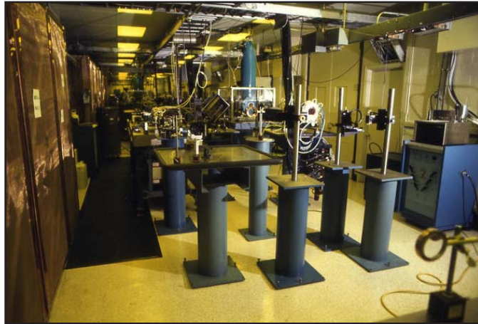
DELTA – 4 beams, 500 J (LLE) Nd:glass, 1 \mu\text{m} (1971)
